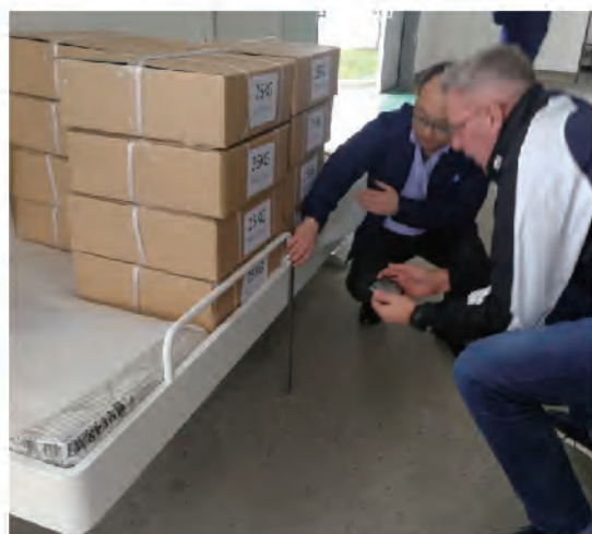
静载荷试验 | Static Load Test
